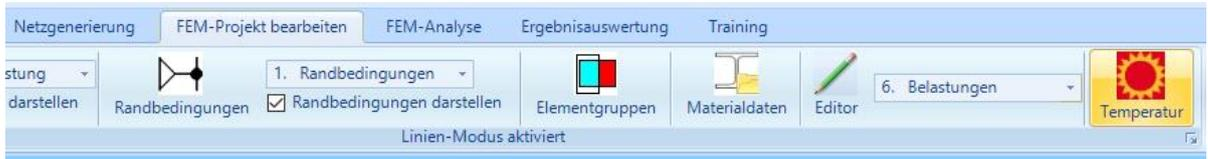
Wählen Sie Menü „Knoten-Temperaturen“ und klicken die Außen-Flächen 1, 2 und 4 an. Diese werden in der Select-Box angezeigt, dort mit Menü „Erzeugen“ die Randtemperaturen erzeugen.
